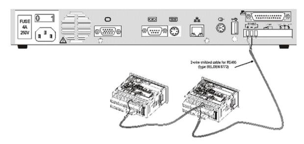
确保线缆的正负极与设备 / 控制器正负极端口一致,不允许不同极性的端子连接在同一条线 上。
