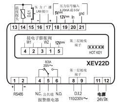
图中文字说明: D.l.1=数字输入 1(无源): 5V=0.5V 比率式压力传感器电源端(驱动器内部自带,不需要外接): 12V=4.20mA 电流型压力探头电源端(驱动器内部自带,不需要外接): ln=压力信号输入端; gnd=接地(2 线式探头不用接此线); W1、W2、12V=双极型步进电机使用 W1、W2 四个端子,单极型步进电机使用 W1、W2、12V 五个端子; HOTKEY=热键编程钥 匙接口; R5485 = R5485 通讯接口; N.C.=常闭触点; N.O.=常开触点; D.l.2=数字输入 2(有源,电压 110Vac 或 220Vac)。
