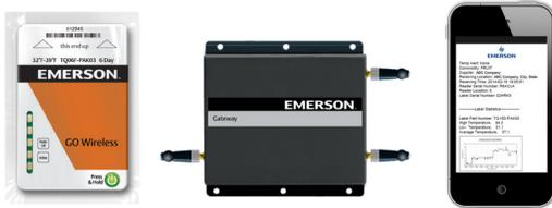
Ein eigenständiges Wireless-System für die optimierte, automatische Temperaturüberwachung. AutoSense™ Gateways werden in Anlagen installiert. Sie sind vorkonfiguriert, verbinden sich beim Einschalten automatisch und erzeugen ihr unabhängiges Netzwerk. Wenn GO Wireless-Rekorder an Behältern ankommen, werden Daten für die weitere Aufbewahrung und Analyse drahtlos an Oversight übertragen. Text- und E-Mail-Alarme werden erzeugt und vordefiniertem Qualitätssicherungspersonal zugestellt.
